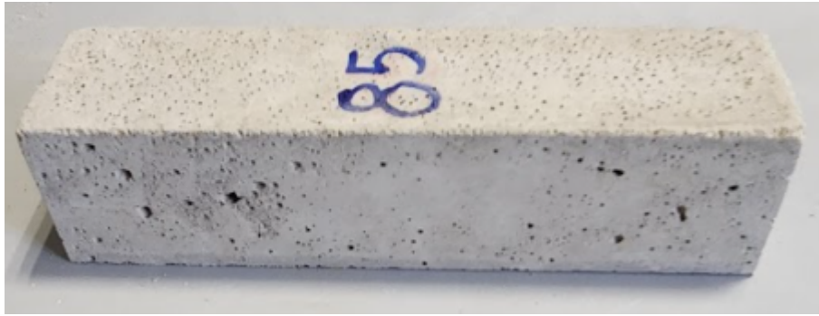
Figura 16: Provete AP com cal depois do aquecimento a 200° C
