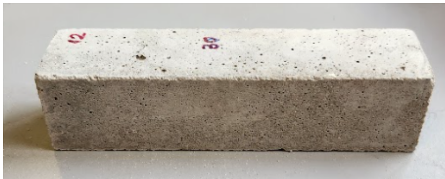
Figura 9: Provede 30% GP antes do aquecimento a 200° C
