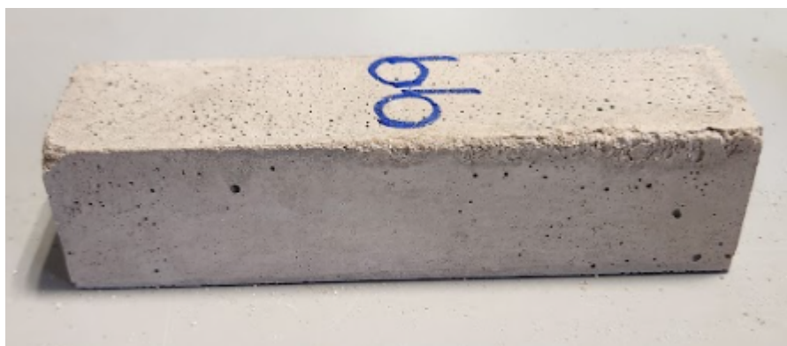
Figura 18: Provete AP com cal depois do aquecimento a 500° C
