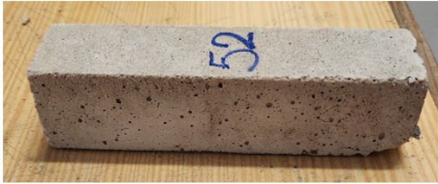
Figura 14: Provete 40% GP depois do aquecimento a 800° C
