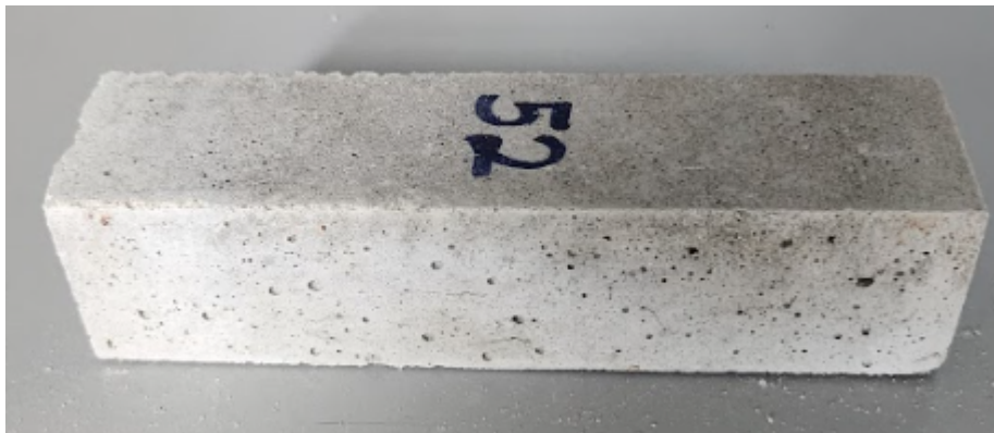
Figura 13: Provete 40% GP antes do aquecimento a 800° C Fonte: Aatoria Própria (2025)
