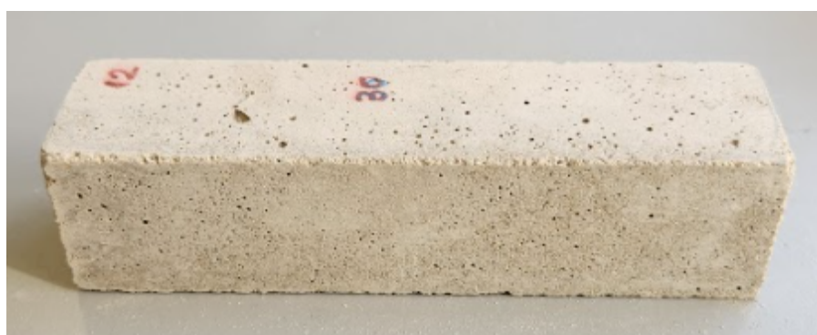
Figura 10: Provede 30% GP depois do aquecimento a 200° C
