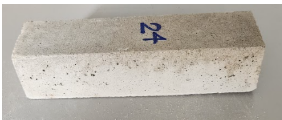
Figura 11: Provede 20% GP antes do aquecimento a 500° C
