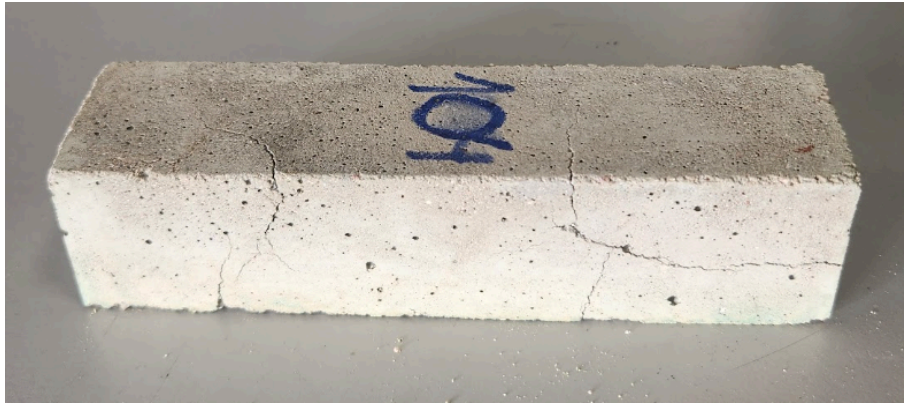
Figura 20: Provede AP bruta depois do aquecimento a 800° C
