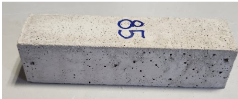
Figura 15: Provete AP com cal antes do aquecimento a 200° C
