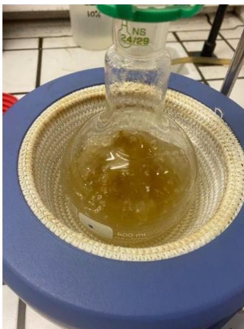
Figura 25 - Fibras na Solução num Balão de 500ml e acoplado a um condensador de 40cm e aquecido numa Manta Térmica.
