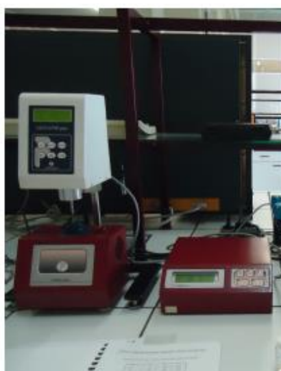
Figura 2.4: Viscosímetro VISCO STAR plus (Fungilab S.A.) e conjunto de spindles utilizados neste trabalho.
