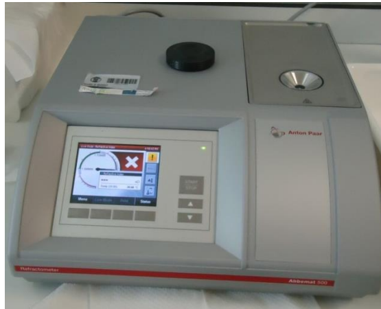
Figura 2.2: Equipamento de medição do índice de refração (refratômetro AbbeMAT 500, marca Anton Paar).
