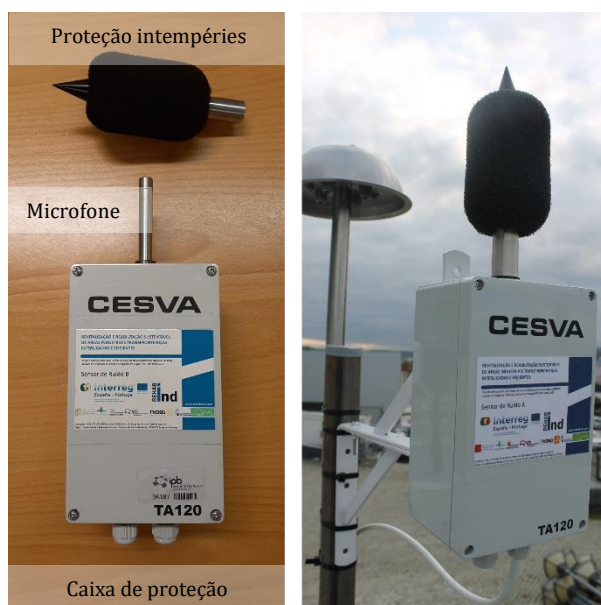
Figura 13 – Sistema de monitorização contínua de ruído. (esquerda) sensor de ruído com as respetivas componentes constituintes; (direita) sistema instalado em campo.
