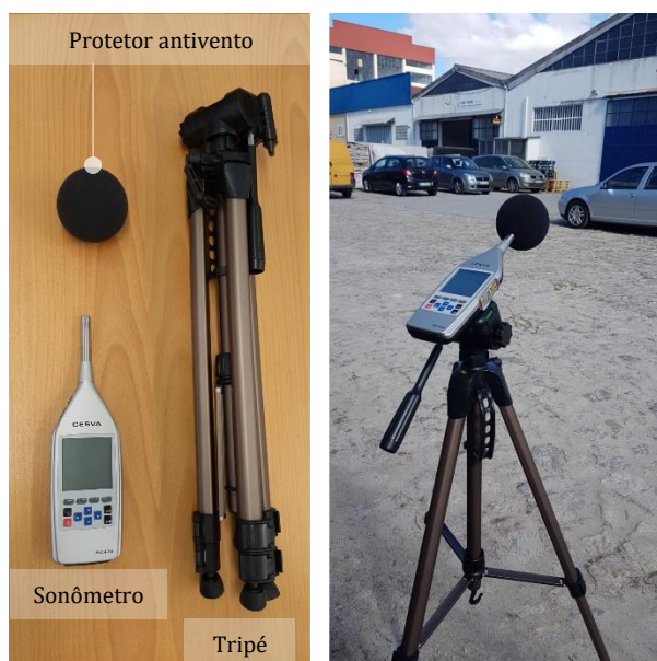
Figura 12 – Equipamentos utilizados para as campanhas de medição de ruído. (esquerda) sonómetro junto ao conjunto de acessórios utilizados; (direita) ilustração da aplicação do sistema de medição.
