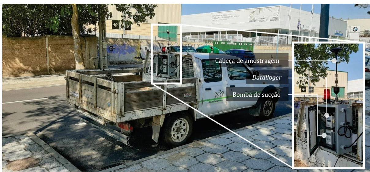
Figura 9 – Método utilizado durante as campanhas de medição de partículas, mostrando o monitor de partículas THERMO ADR-1200S (em destaque) montado sobre uma carrinha
