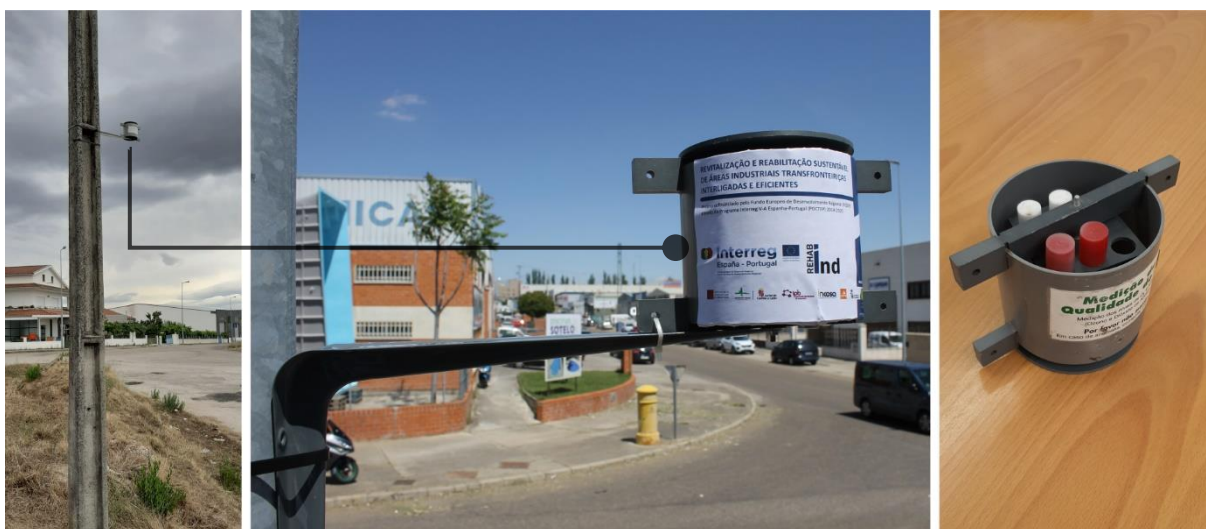
Figura 11 – Método de amostragem passiva; (esquerda) abrigo fixado num dos locais de medição; (centro) visão do abrigo em detalhe; (direita) abrigo sem a tampa superior mostrando a forma como os tubos passivos são colocados no seu interior
