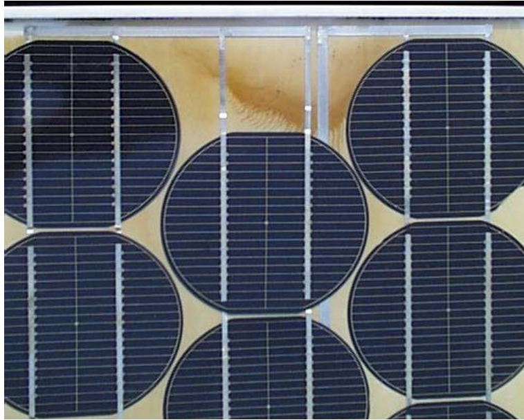
Figura 5.2 - Degradação do encapsulante [28]
