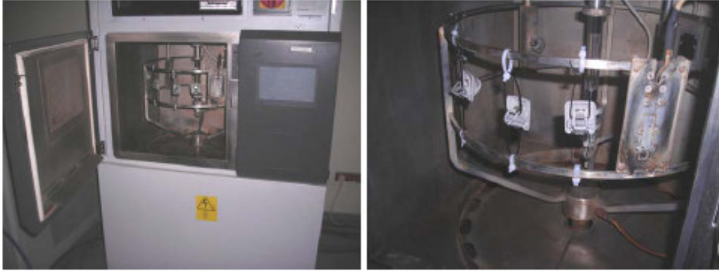
Figura 22 - Crochet B9 no Xenon test
