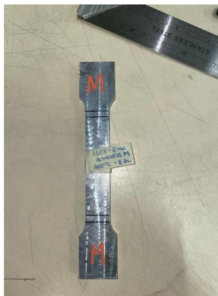
Figura 26 – Corpo de prova de tração identificado e demarcado
