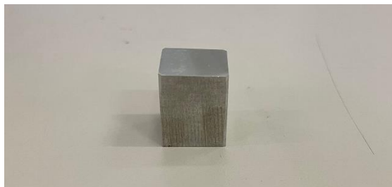
Figura 16 – Corpo de prova de metalografia usinado
