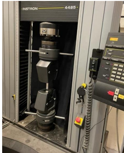
Figura 25 - Máquina universal de ensaios mecânicos utilizada no ensaio de tração
