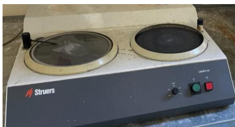
Figura 23 - Polidora Struers LaboPol 25
