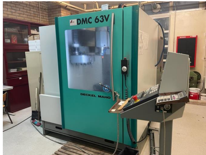
Figura 12 - Fresadora CNC Deckel Maho modelo DMC 63V
