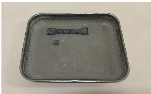
Figura 19 – Amostras de tração e metalografia aguardando tratamento térmico
