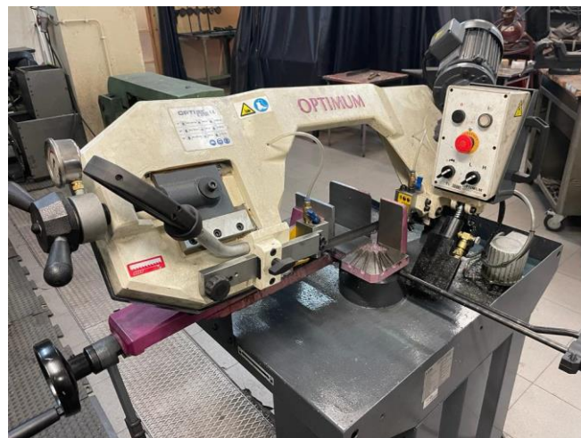
Figura 15 - Serra de fita com braço rotativo modelo Optimum S 210G
