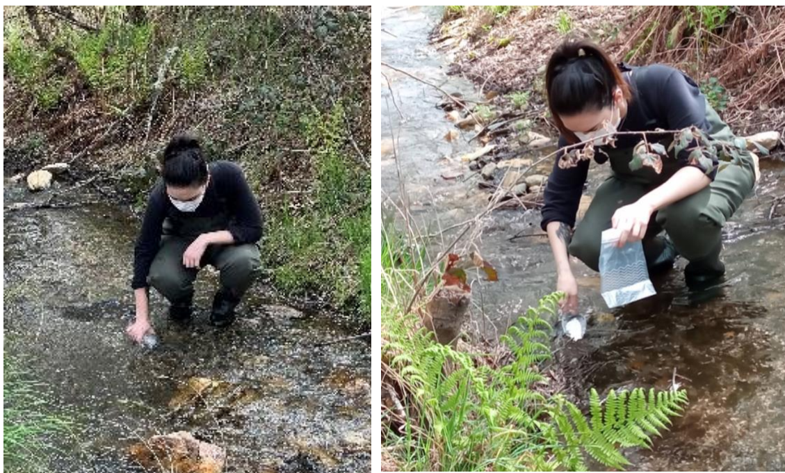
Figure 32 - Obtenção de amostras de água e sedimentos superficiais para análise laboratorial dos metais pesados.
