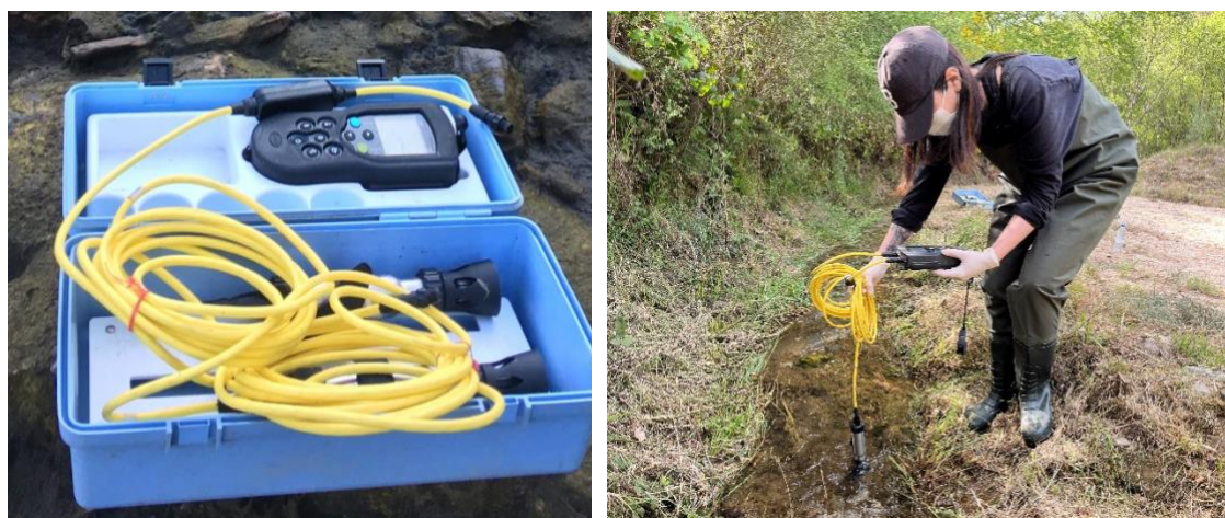
Figura 12 - Mensuração, in situ , de parâmetros físico-químicos da água.
