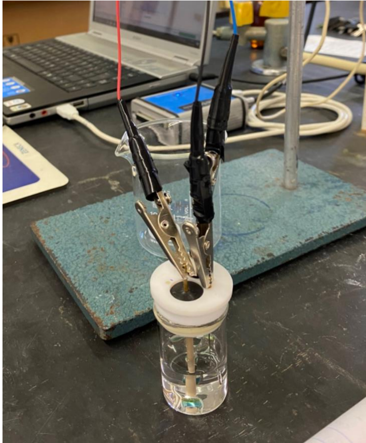
Figura 34 - Célula eletroquímica composta pelos três elétrodos (trabalho, referência e oposto).
