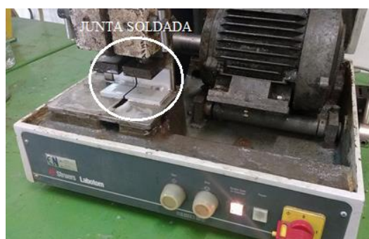
Figura 37 – Processo de corte das juntas soldadas.
