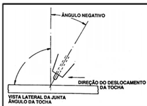
Figura 11 – Posicionamento da tocha na soldadura MIG [43].
