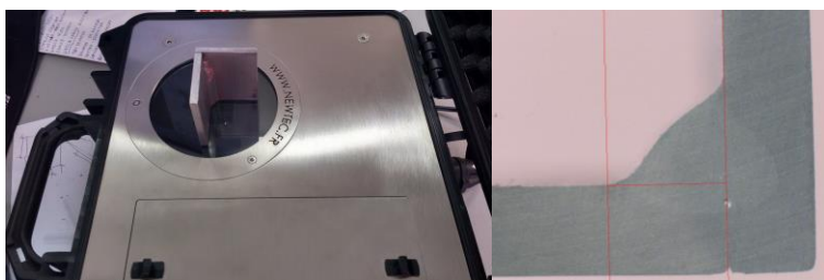
Figura 39 – Processo de análise do cordão de solda com auxílio de microscópio.
