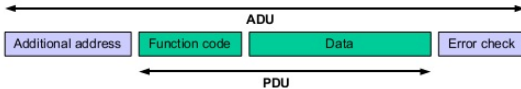
Figura 3.4: Estrutura de uma mensagem Modbus [12]
