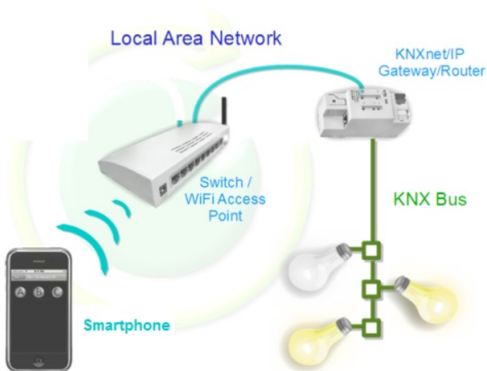
Figura 3.1: Exemplo de um controlo de uma lâmpada através de wifi
