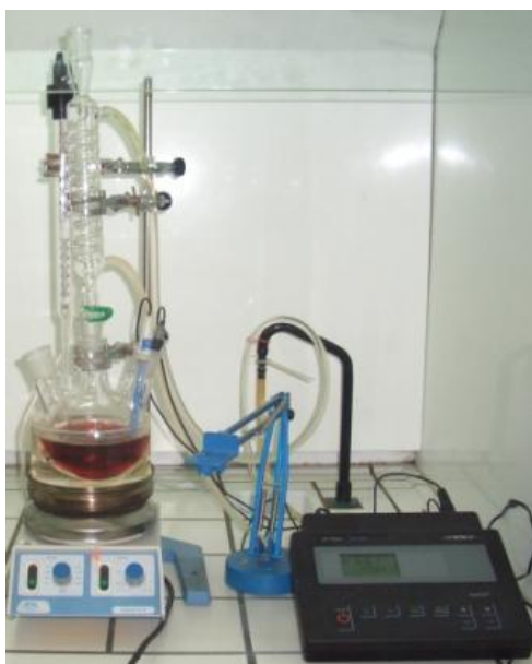
Figura 9 - Esquema de montagem do reactor utilizado nos ensaios de adsorção e de peroxidação.
