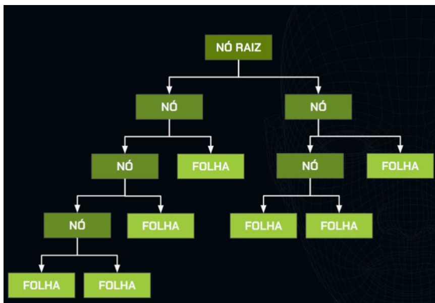
Figura 50: Estruturação de uma Árvore de Decisão com seus nós de decisão e os nós folha. Fonte: Alura.
