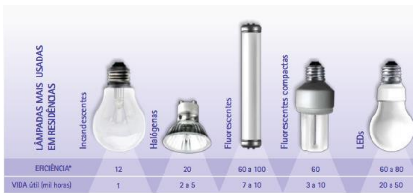
Figura 2.3-2 Eficiência e vida útil dos vários tipos de lâmpadas
