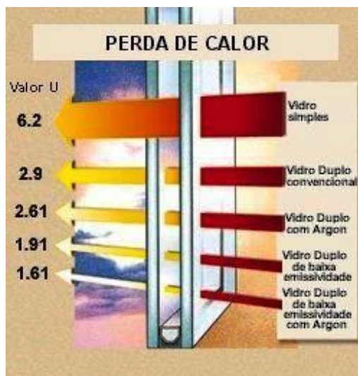
Figura 2.2.1-1 Perda de calor de acordo com o tipo de vidro (Vidraria FOCO, 2014)
