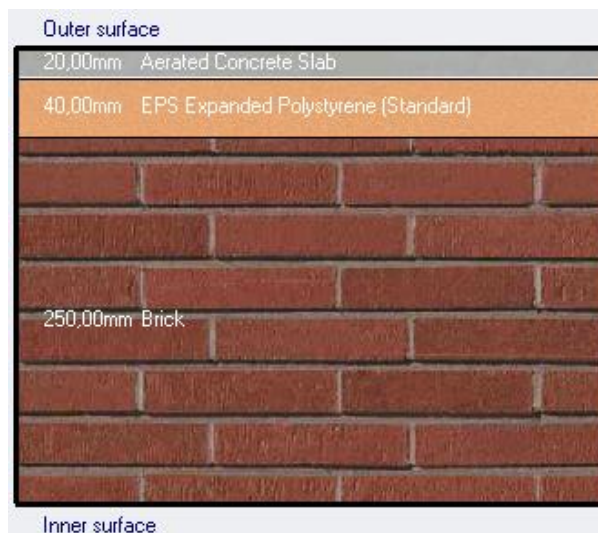
Figura 5.2.1-1 Estrutura da parede exterior
