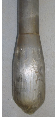
Figura 4 – Vara e ponteira usada no DPSH
