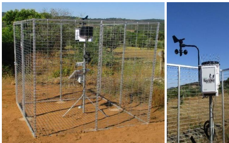
Figura 68– Vista geral e de pormenor da EMA instalada no SD de Porto de Espada (foto em julho de 2019).
