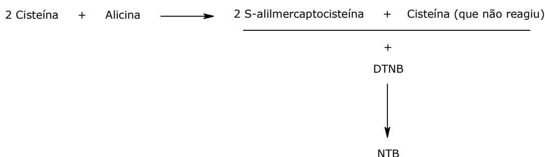
Figura 1.4 – Representação geral das reacções que ocorrem na aplicação do Método Cisteína .
