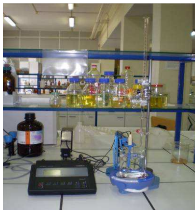
Figura 3.15 – Instalação experimental para o acerto do pH da solução de Hepes no Método Cisteína.
