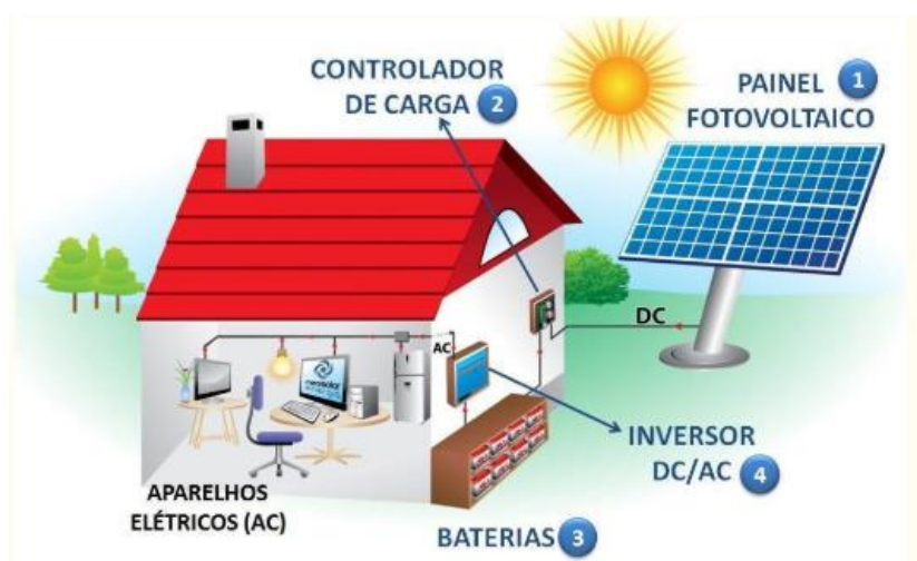
Figura 5 - Sistema Isolado ou Autônomo (NEOSOLAR, 2018).
