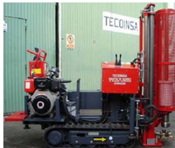
Figura 3 – Ensaio com penetrómetro dinâmico (DP). Equipamento de ensaio do Instituto Politécnico de Bragança.
