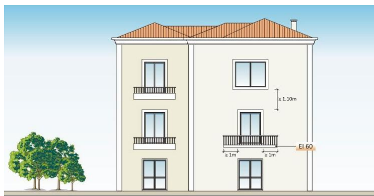
Figura 2.6 - Afastamento de vãos na fachada [3].
