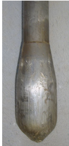
Figura 4 – Vara e ponteira usada no DPSH
