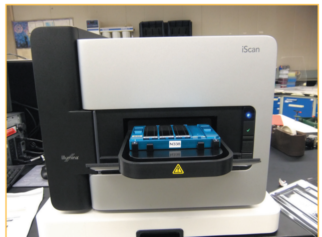
Figura 3 - (b) iScanReader da Illumina é usado para analisar o sinal de fluorescência do BeadChip.
