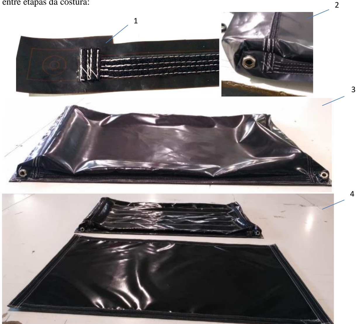
Figura 4.10 - Etapas da costura do coletor. 1 – Costura do Velcro nas paredes laterais; 2 – Costura das paredes laterais com a peça superior; 3 – Costura entre as peças superior e inferior; 4 – Coletor completamente cosido
