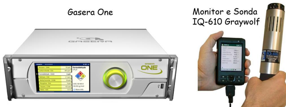
Figura 25 – Instrumentos de "referência" utilizados na amostragem de gases e parâmetros ambientais. Fonte: Adaptado de Gasera (2019) e Graywolf (2014).
