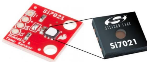
Figura 17 – Sensor Si7021 da Sparkfun de temperatura e humidade relativa. Fonte: Adaptado de Sparkfun (2019b); Silicon Labs (2016).
