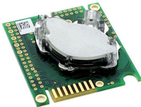
Figura 14 – Sensor K30 da CO2meter de dióxido de carbono. Fonte: Adaptado de CO2meter (2015).
