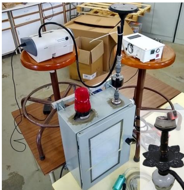
Figura 26 – Esquema montado para validação do sensor de material particulado e narguilé utilizado para produção das partículas.
