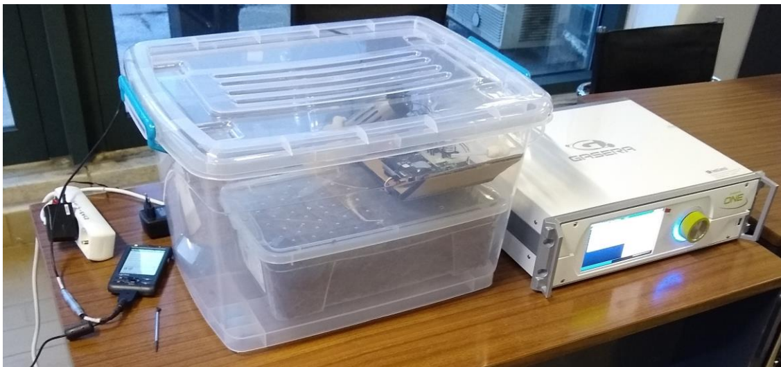
Figura 24 – Esquema montado para validação dos sensores de NH 3 , CO 2 , T e HR.
