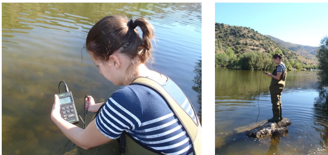
Figura 3.11. Medição dos parâmetros físico-químicos da água no rio Sabor (setembro 2010).
