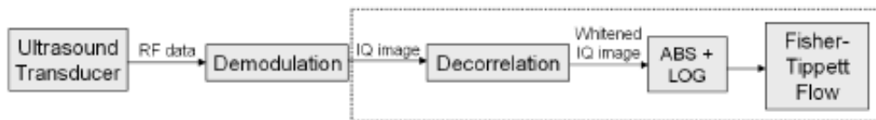
Figura 3.1 - Diagrama do procedimento de aquisição de imagem ecográfica [34]
