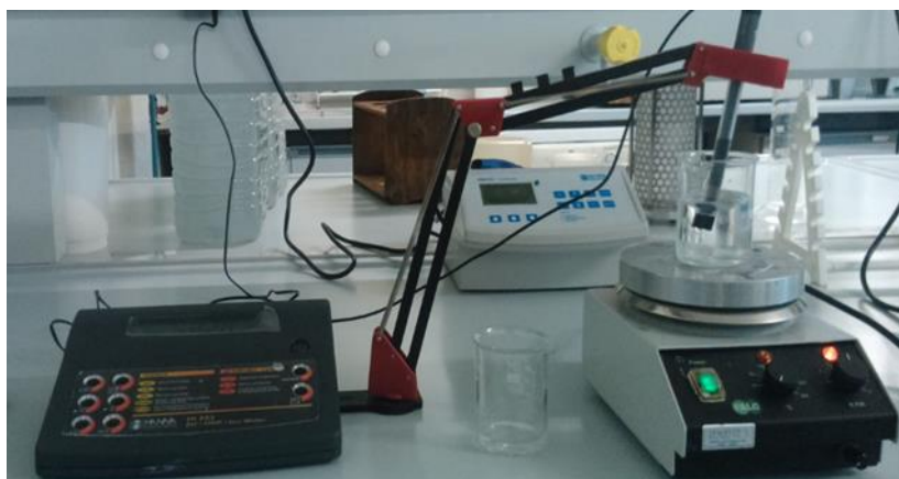
Figura 3.6 – Eléctrodo utilizado na determinação do azoto amoniacal
