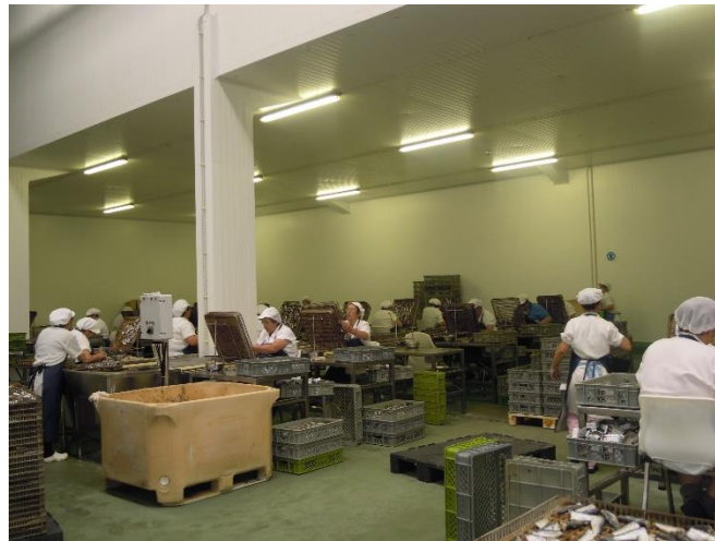
Figura 2.4 – Operação manual de enlatamento
