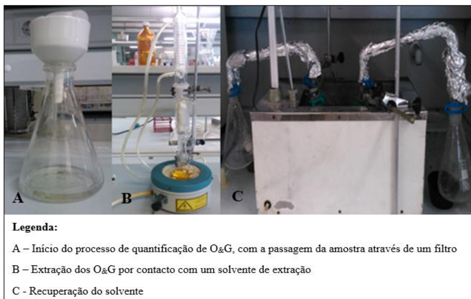
Figura 3.3 – Instalação experimental para a determinação de O&G
