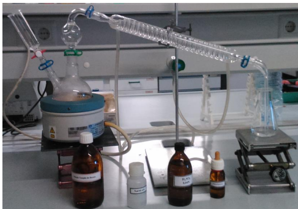
Figura 3.5 - Instalação experimental para a destilação da amostra
