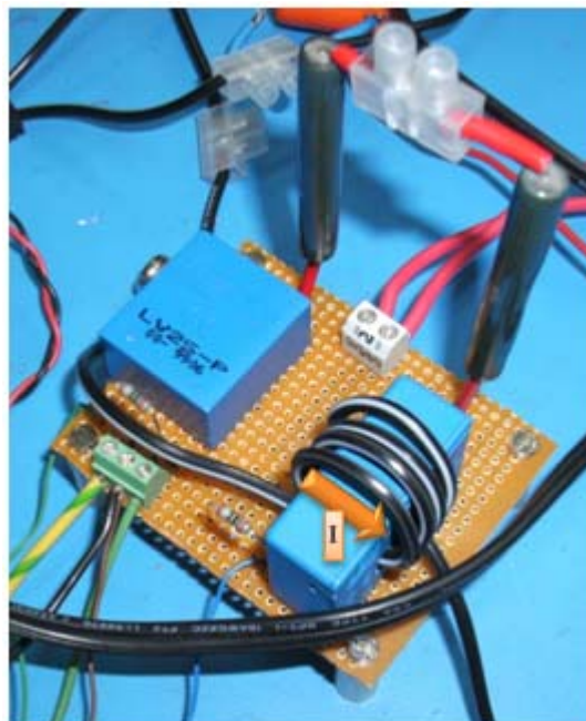
Figura 4-6: Circuito experimental de medida de tensão e corrente.
