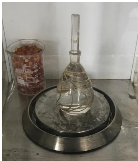
Figura 9: Massa do picnômetro + água destilada + amostra de fibra seca.
