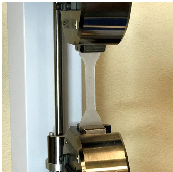
Figura 16: Ensaio de tração para o provete de Resina Poliéster.
