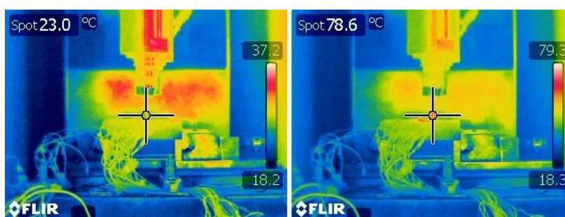
Figura 24 - Temperatura na broca antes (imagem da esquerda) e após (imagem da direita) a furação do material.
