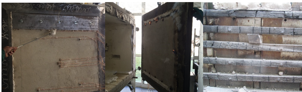
Figura 8: Ensaio da parede de tabique
