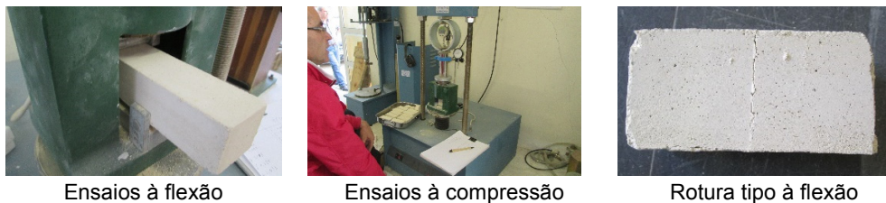
Figura 2: Ensaio à flexão e à compressão
