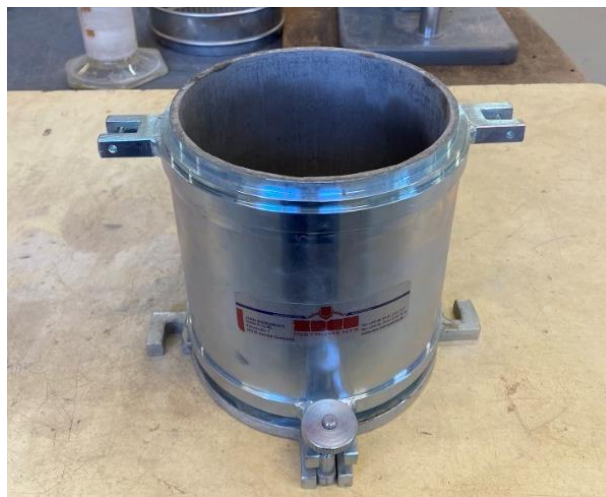
Figura 34 – Molde para preparação da amostra do CBRd
