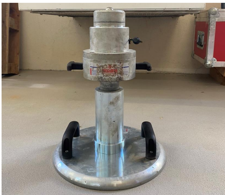
Figura 29 - extensor do equipamento ZFG 3.0 e placa de carga de 300 mm característica para CBR dinâmico
