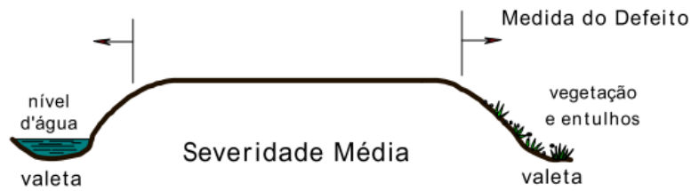
Figura A6 – Drenagem Lateral Inadequada – Média Fonte: Oda (1995)
