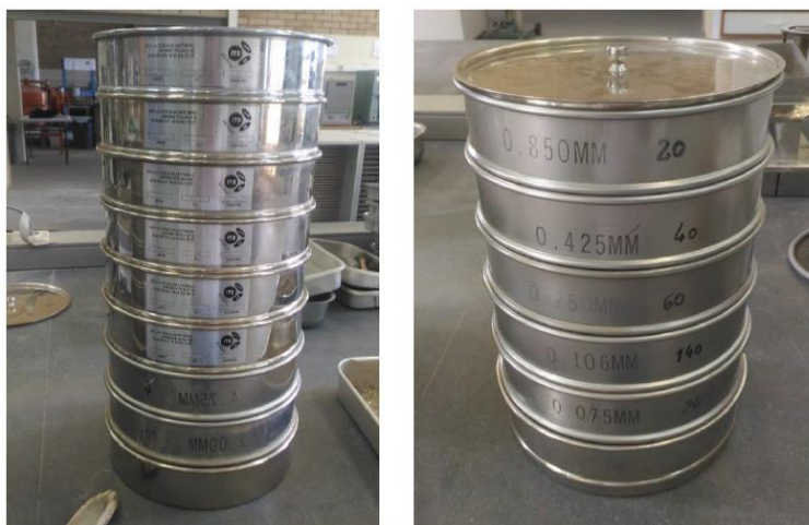
Figura 18 – Conjunto de peneiras necessárias para o ensaio de granulometria Fonte: (Cabette, 2018)
