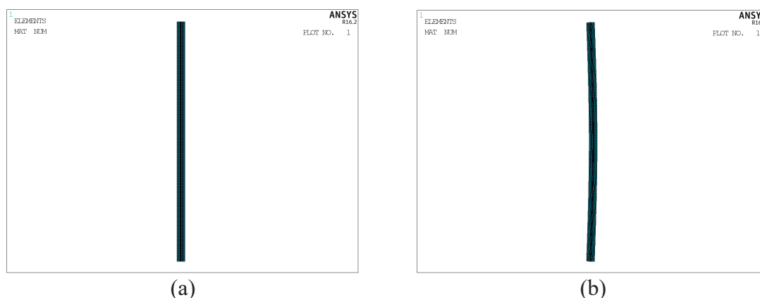
Figura D.18: Representação da coluna sem imperfeições geométricas (a) e com a geometria atualizada (b) de acordo com CEN - EN 1993-1-1.
