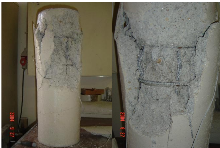
Figura 4.8 – Fenómeno de fendilhação e descolamento do betão de recobrimento, observados durante o ensaio dos cilindros de betão armado.
