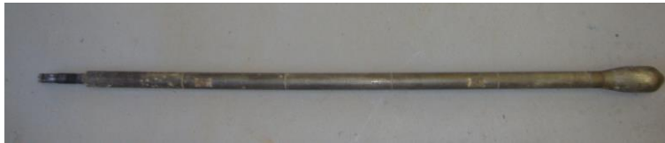
Figura 4 – Vara e ponteira usada no DPSH
