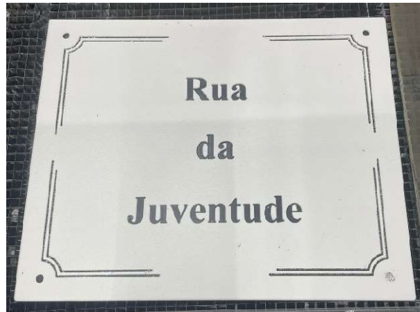
Figura 16 Placa de sinalização, obtida através de fresadora CNC
