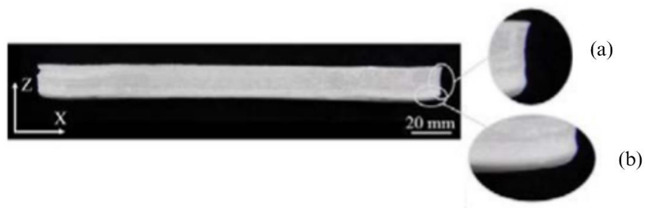
Figura 6 - Efeitos típicos de empenamento na impressão 3D. (a) pincushion e (b) curling. Adaptado de [16]
