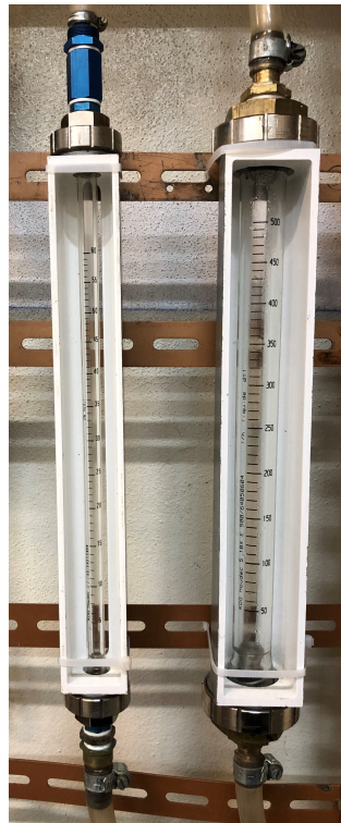
Figura 4.2: Rotâmetro para medição do caudal de água, R1 da esquerda e R2 da direita.
