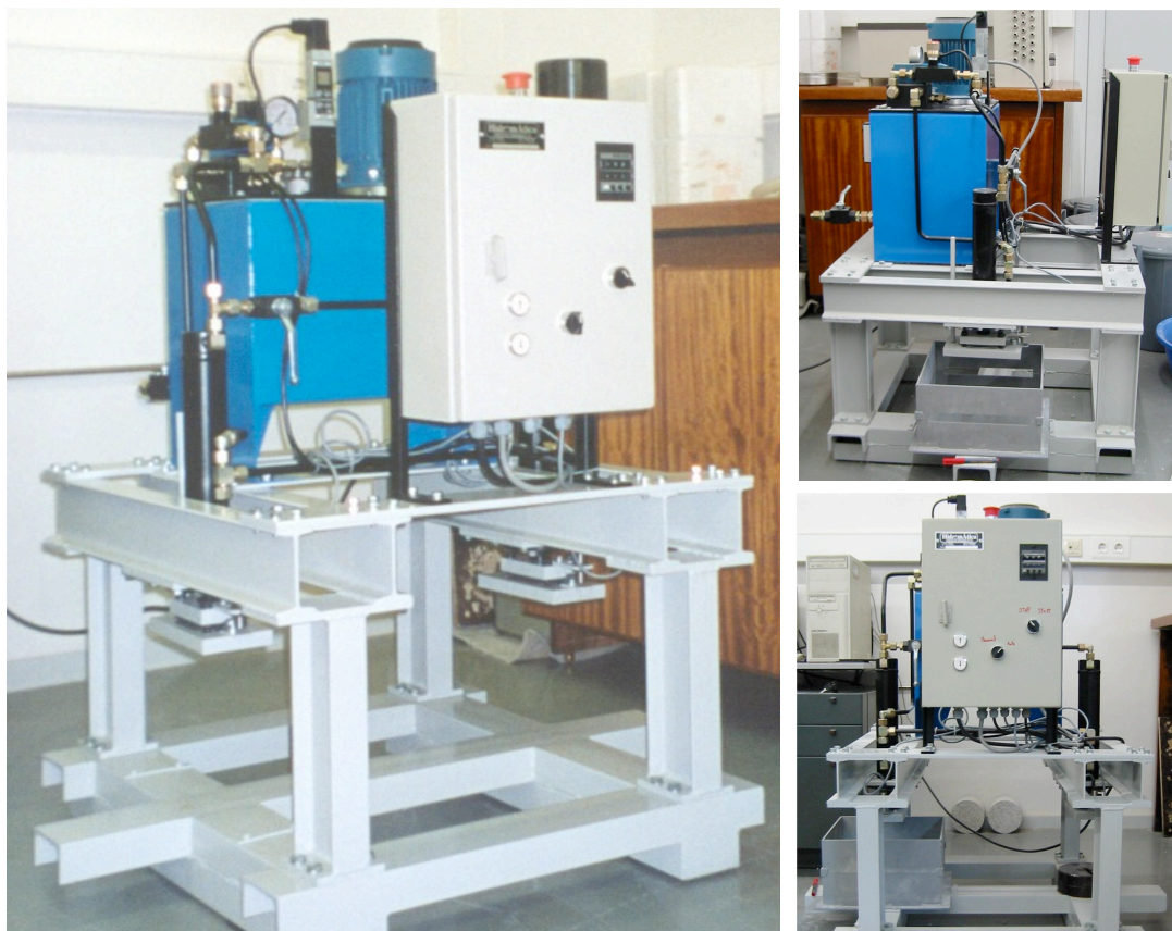
Figura 11 - Aspecto geral do equipamento de ensaio laboratorial de danificação de geossintéticos (ENV ISO 10722-1) - vistas gerais da estrutura de suporte sem e com caixa de danificação posicionada.
