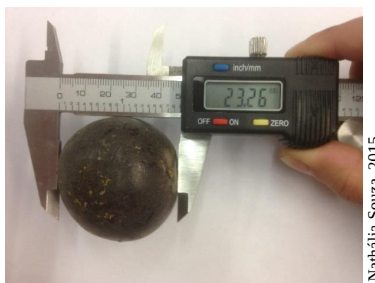
Figura 3. Execução da medição do comprimento e da largura dos frutos.
