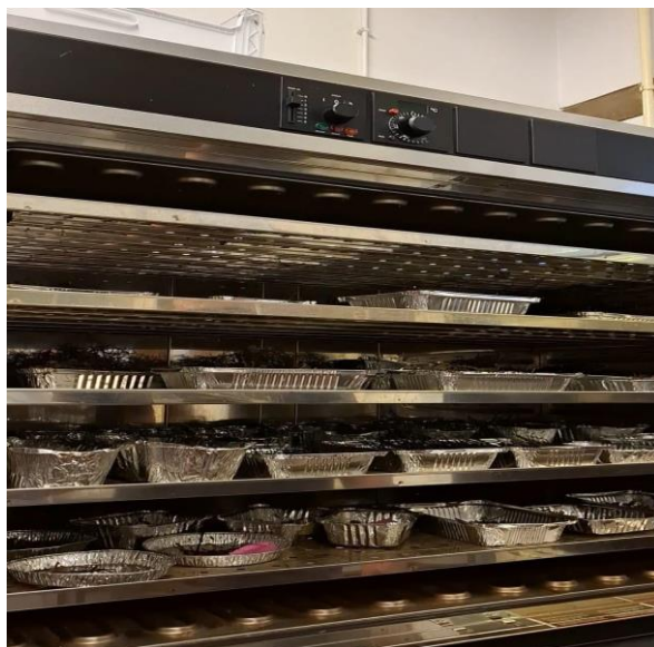
Figura 6 – Secagem de amostras de biomassa vegetal para determinação do teor de matéria seca (MS).
