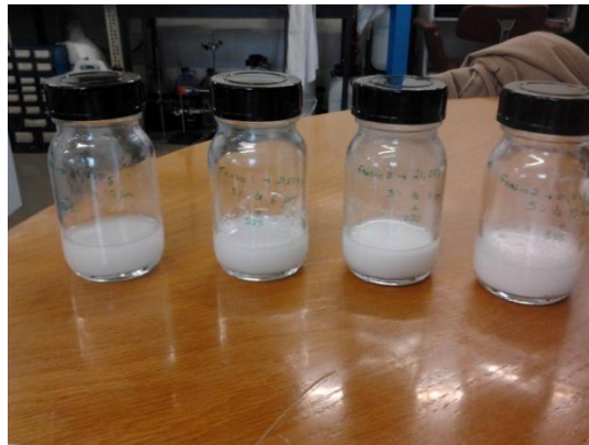
Figura 17. Soluções poliméricas com diferentes concentrações de micropartículas de PMMA de 6 e 10 \mu\text{m} de diâmetro.
