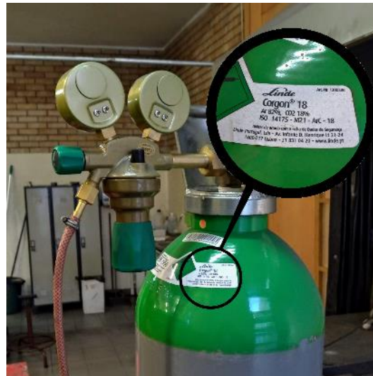
Figura 25: Gás de proteção utilizado: Ar 82% e CO 2 18%
