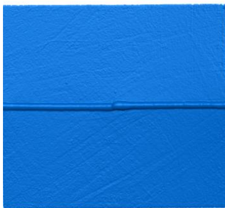
Malha do provete SS_3 adquirida pelo MetraSCAN 3D
