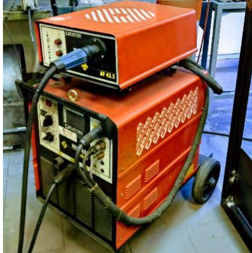
Figura 23: Máquina de soldadura MIG 453 Modular
