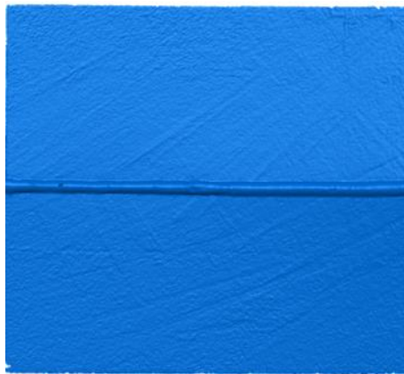
Malha do provete SR_2 adquirida pelo MetraSCAN 3D
