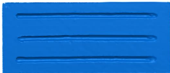
Malha do provete L[u]_3 adquirida pelo MetraSCAN 3D
