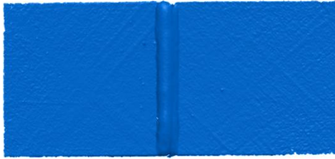
Malha do provete M[u]_1 adquirida pelo MetraSCAN 3D
