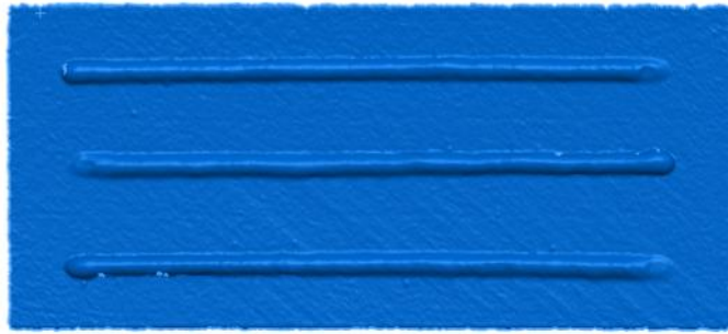
Malha do provete L[a]_1 adquirida pelo MetraSCAN 3D
