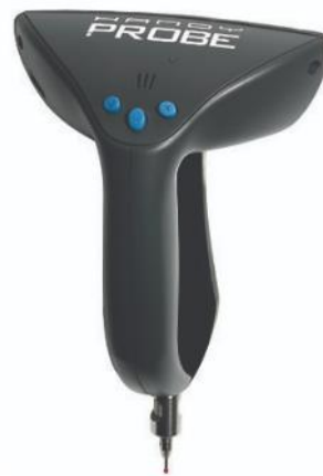
Figura 28: Equipamento portátil para medição de coordenadas (HandyPROBE)
