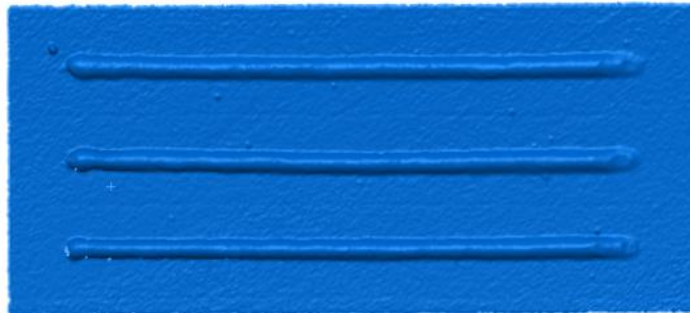
Malha do provete L[u]_2 adquirida pelo MetraSCAN 3D
