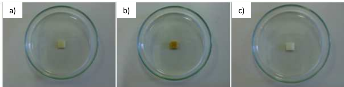
Figura 5.1. Espumas rígidas de poliuretano, (a) espuma Indulin AT, (b) espuma Alcell e (c) espuma comercial.
