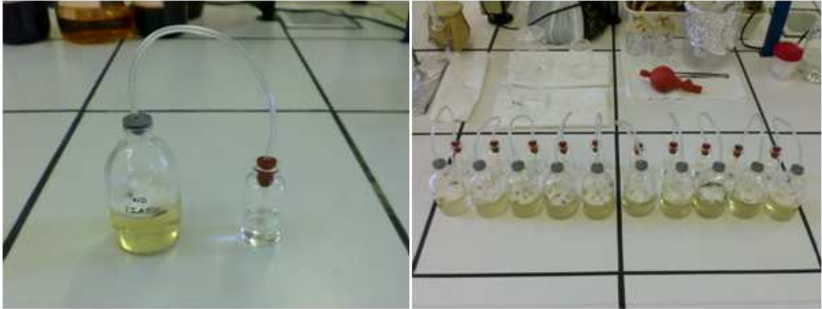
Figura 5.9. Montagem dos testes de biodegradação em meio líquido.
