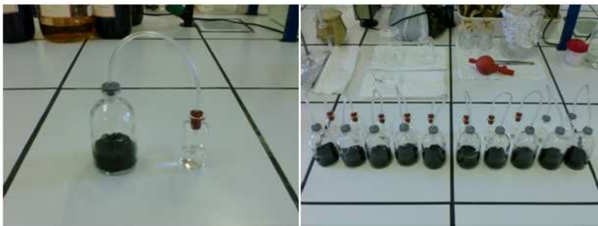
Figura 5.15. Montagem dos testes de biodegradação em meio sólido sem inóculo.
