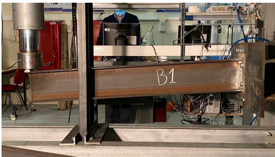
(a) Viga B1 após a realização do ensaio
