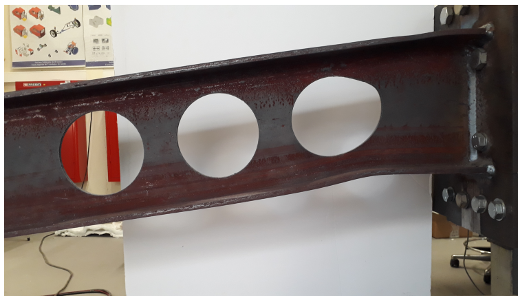
Figura 4.24: Deformação plástica na Viga B7 após retirada da carga.
