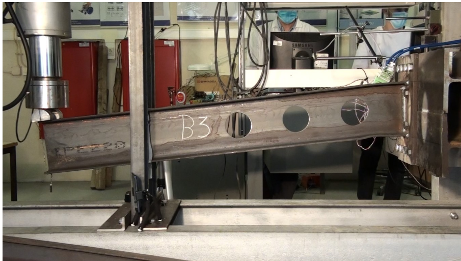
(c) Viga B3 após a realização do ensaio
