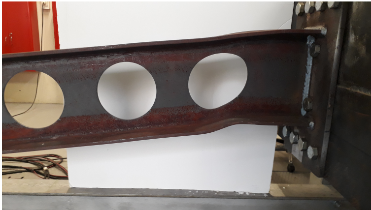
Figura 4.25: Deformação plástica na Viga B8 após retirada da carga.
