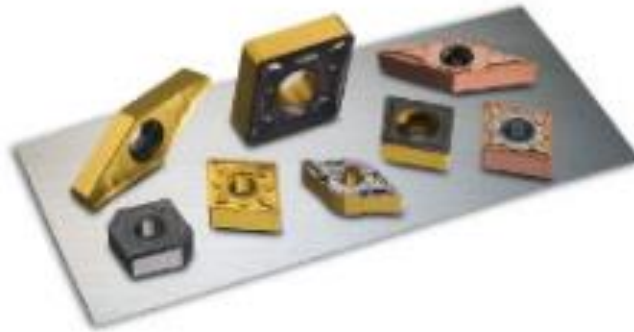
Figura 16 - Exemplos de matérias das ferramentas de corte fabricadas em metal duro revestido [25]
