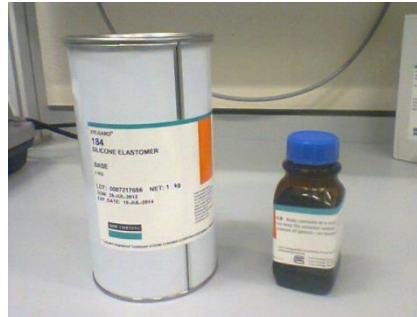
Figura 1: Polidimetilsiloxano (PDMS) pré-polímero e agente de cura.
