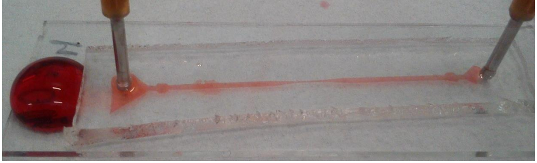
Figura67: Rompimento na entrada do canal com estreitamento.
