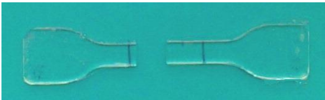
Figura29: Imagem representativa da rutura correta do provete, para que este possa ser válido.
