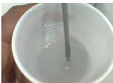
Figura19: Mistura do PDMS com uma espátula.
