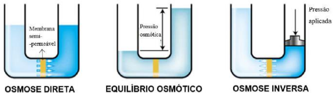
Figura 2 – Processo da Osmose Inversa. (Gaio, 2016)
