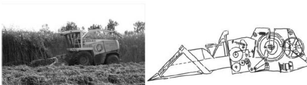
Figura 1. Sistema de colheita HempCut 3000/4000 e esquema de funcionamento da faca e tambor de corte (Amaducci and Gusovius 2010).
