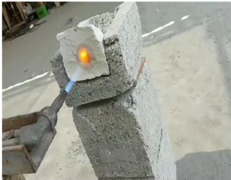
Figura 5 - Teste da argamassa utilizando tocha de corte a gás,[17].
