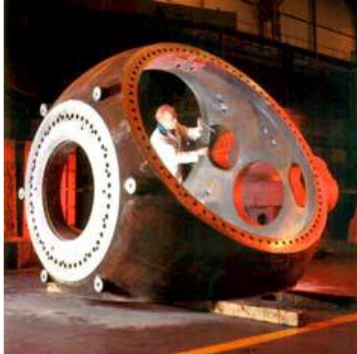
Figura 13-Detalhe de um cubo para conexão de pás [3]
