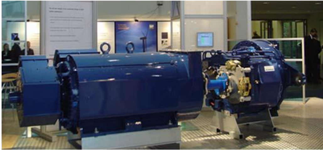
Figura 15-Gerador conectado a caixa de engrenagens [3]
